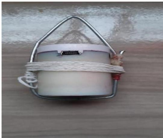
**Figura 19:** Minicaixa de som acoplada com o arame.
