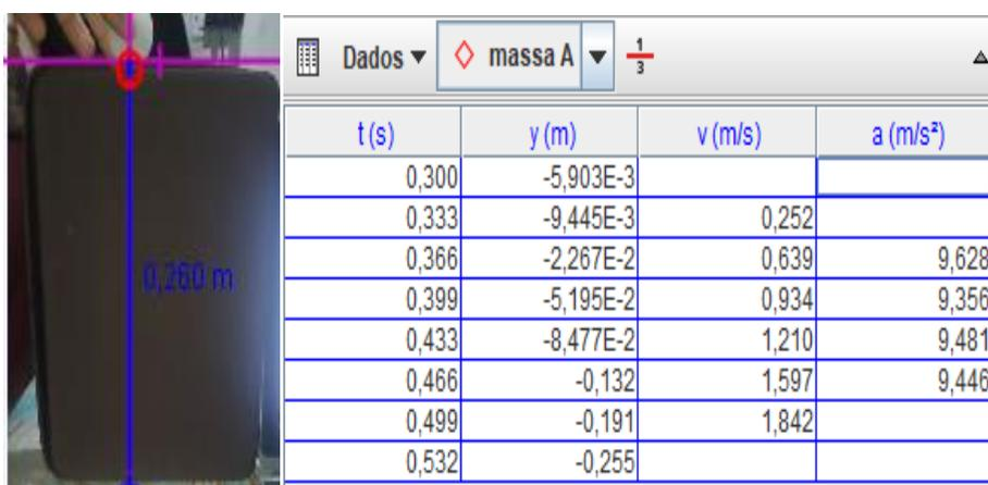
**Figura 8:** Zoom da tabela de dados obtidos no rastreo da esfera, destacando-se a velocidade (v) e a aceleração (a).
