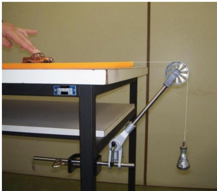
**Figura 2:** Experimento da segunda lei de Newton com auxílio do *Tracker*.
