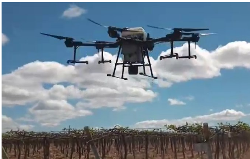
Figura 3 - Uso do drone na agricultura para pulverização.
