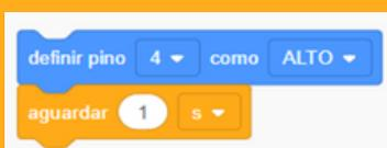
6- Repita os mesmos procedimentos acima, mudando só o estado da porta do arduino de alto para baixo, clicando na seta do bloco. Em seguida, encaixa no bloco de tempo do passo 5, ficando dessa forma:
