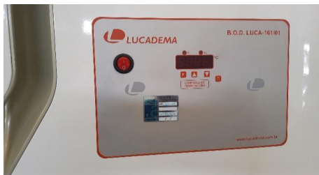
Figura 14 - Painel de controle da DBO
