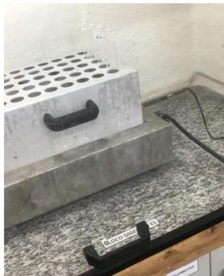
**Figura 02** - Bloco digestor para determinação dos teores de proteínas.
