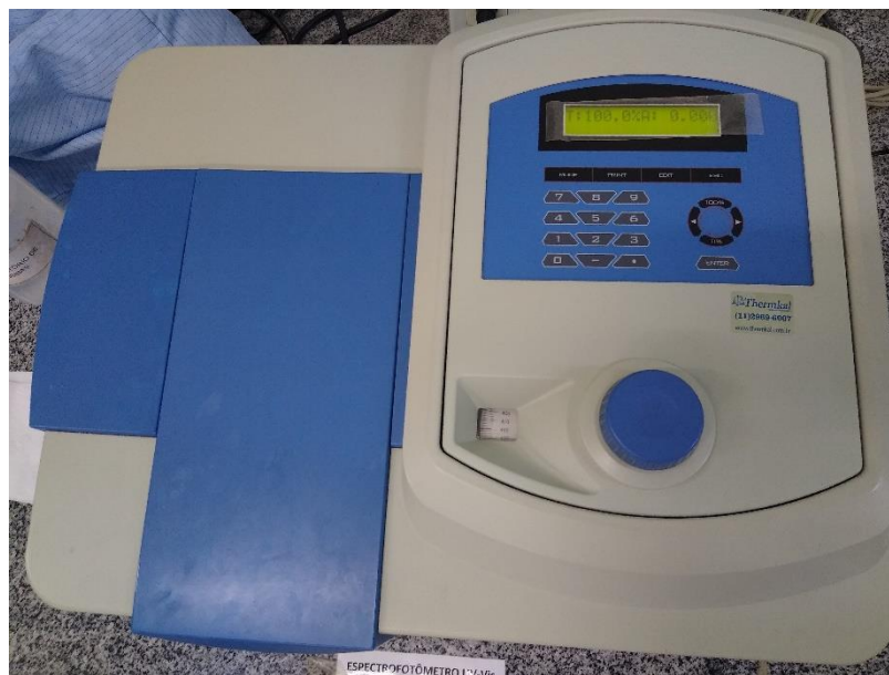
Figura 14. Análise da coloração da cerveja usando espectrofotômetro UV-Vis
