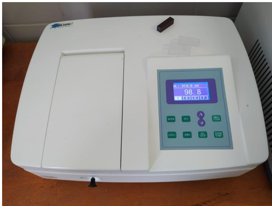
Figura 10 – Espectrofotômetro configurado para \lambda = 350,0 nm contendo três amostras no seu interior e exibindo em seu visor a transmissividade de uma delas como sendo de 98,8%.
