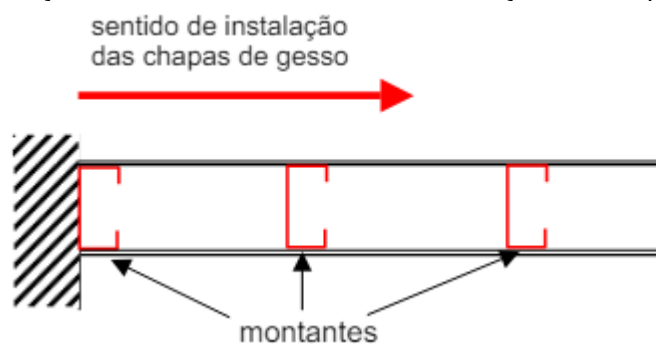
Figura 10: Direção dos montantes e sentido de colocação das chapas de gesso.
