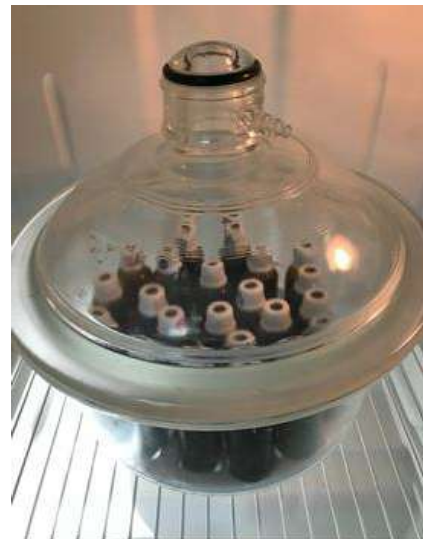
D – Dessecador com solução saturada de NaCl contendo os recipientes de vidro
