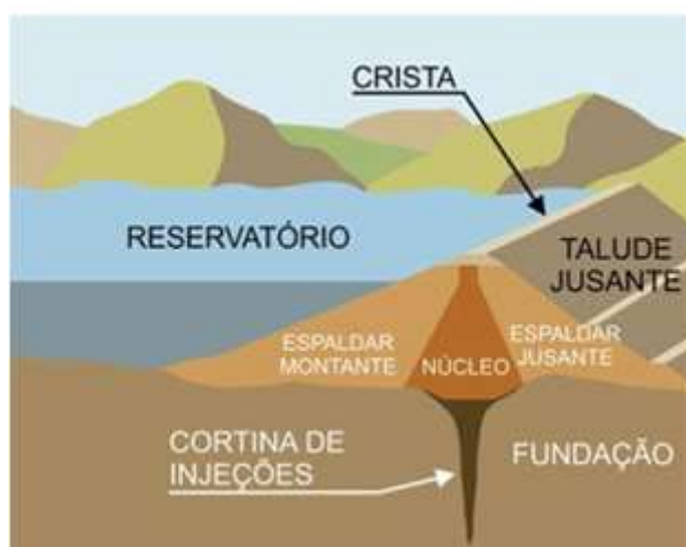
Figura 1 - Vista Geral de uma Barragem
