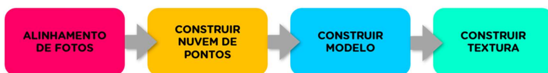
Figura 17 - Fluxo de trabalho padrão para geração de modelos tridimensionais
