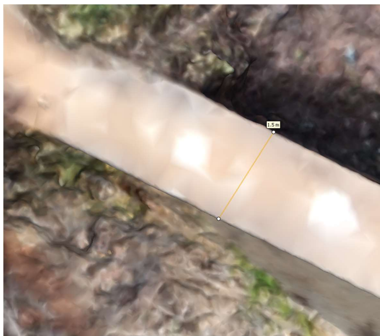
Figura 39 - Medida do coroamento - Mapeamento 09/12/23
