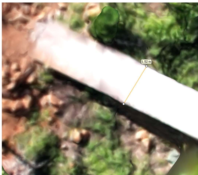
Figura 40- Medida do coroamento - Mapeamento 29/06/24
