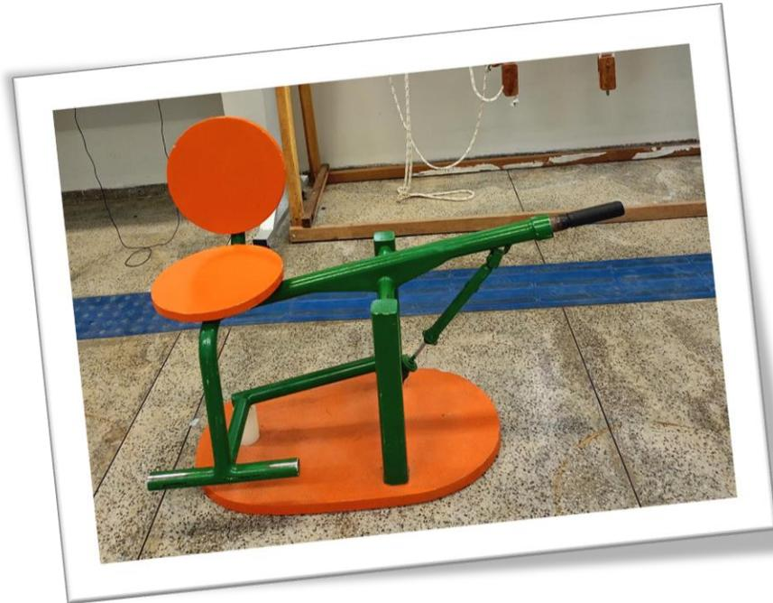
A alavanca é uma barra rígida móvel, ancorada em um ponto fixo ou ponto de apoio. Quanto mais distante do ponto de apoio, menor será a força necessária aplicada para deslocar ou elevar um peso.
