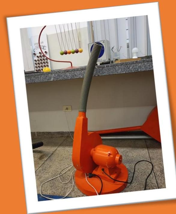
O experimento da bola flutuante é realizado com um aparelho e uma bola de isopor, explicado pelo princípio de Bernoulli.
