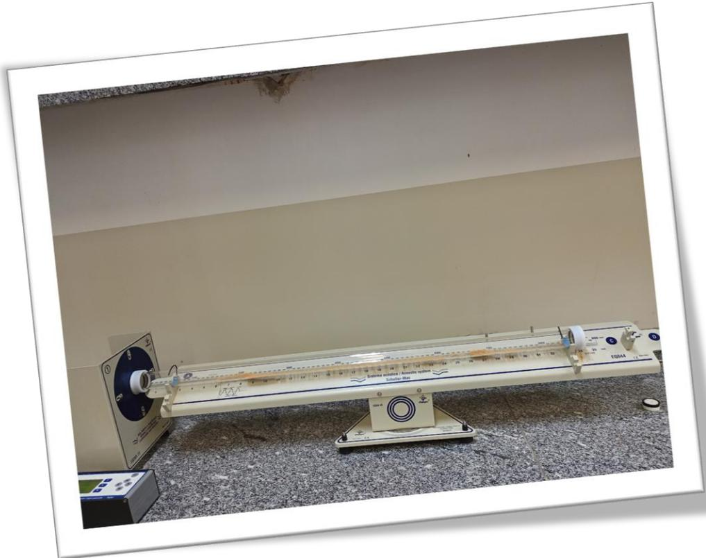
Equipamentos do sistema acústico: Tubo de Kundt, alto-falante e fonte de frequência; demonstração de funcionamento para o público
