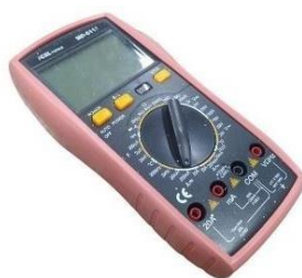
Figura 16 - Multímetro utilizado na função amperímetro para aferir a corrente elétrica do TRC
