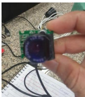
Figura 13: Rede de difração acoplada ao webcam.
