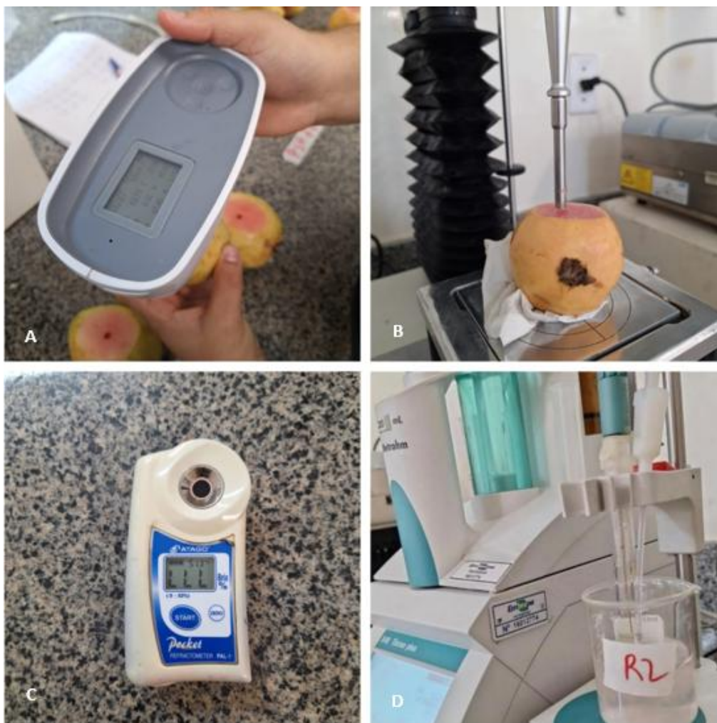
Figura 3 – Aparelhos utilizados para realizar as análises físicas e químicas das goiabas. Colorímetro portátil Delta Vista 450G (Delta color, SP, Brasil) (A); Penetrômetro digital modelo TA. XT PLUS (Extralab, SP, Brasil) (B); Refratômetro digital modelo Pal 1 (Atago, SP, Brasil) (C); Titulador com potenciômetro 848 Titrino plus (Metrohm, Herisau, Suíça) (D).
