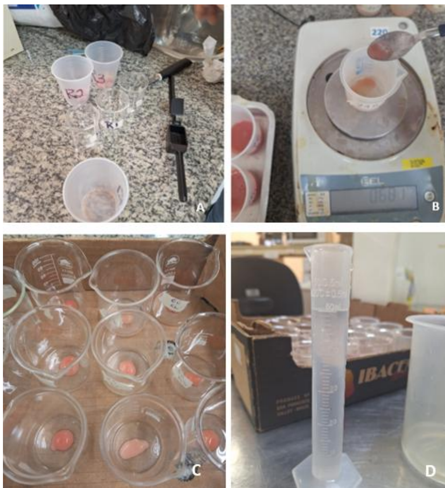
Figura 4 - Suco da polpa obtido com o auxílio de um espremedor (A); Pesagem de amostra de 1g de suco de goiaba com balança eletrônica S2202H - 2200g x 0,001g (Bel Equipamentos, SP, Brasil) (B); Becker usado para análise de acidez (C) e Proveta graduada com 50 mL de água destilada (D).
