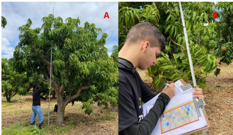
Figura 3 – 3A - Medição da altura total ( h ) com a utilização da mira topográfica; 3B – Anotação das medidas de altura e CAP
