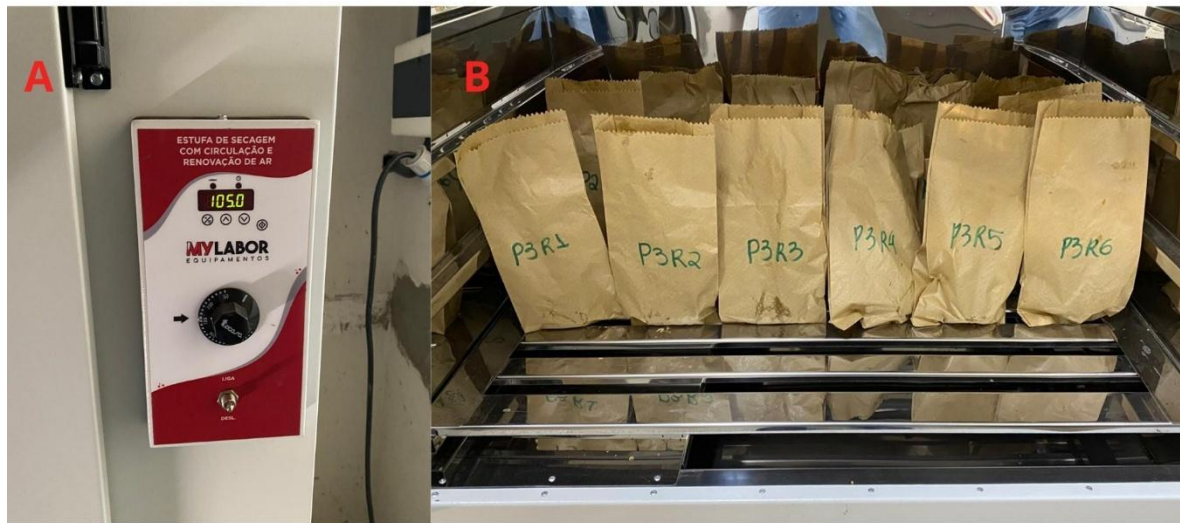
Figura 8 – 8A – Termostato da estufa marcando 105 °C - 8B - Amostras colocadas em estufa a temperatura constante de 105 ± °C
