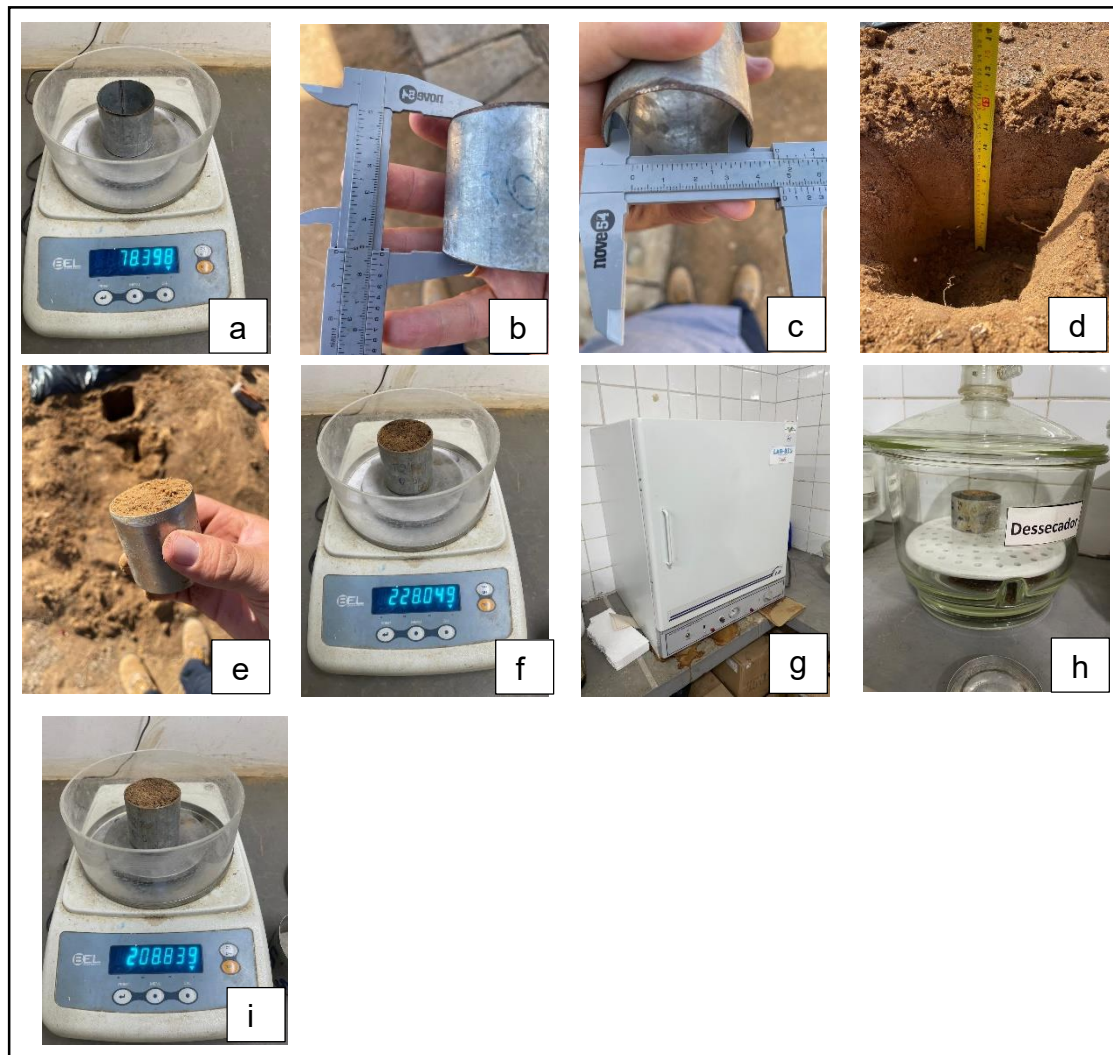
Figura 2. a) pesagem do anel volumétrico; b) altura do anel volumétrico; c) diâmetro do anel volumétrico; d) profundidade da coleta; e) coleta de solo; f) pesagem do solo úmido; g) secagem em estufa; h) resfriamento do solo; i) pesagem do solo seco.
