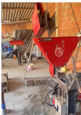
Figura 22: Produção do tijolo ecológico prensado
