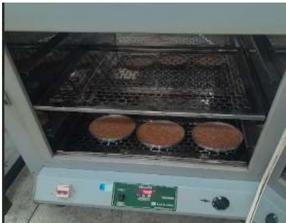
Figura 3 – Processo de secagem realizado em estufa com circulação de ar forçado (A) em três repetições (B)
