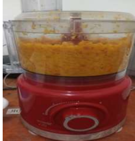
Figura 2 – Cascas de laranja-pera (A) e tangerina (B) trituradas para aplicação do processo de secagem em leito fixo
