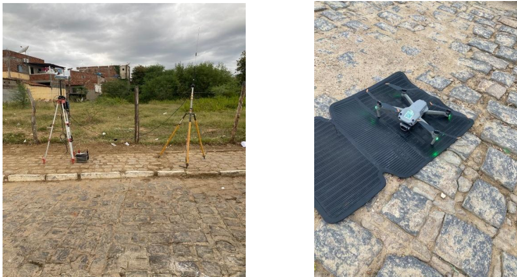
Figura 11 - RTK e Drone
