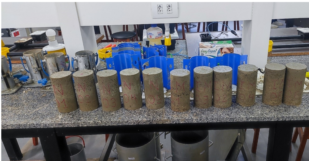
Figura 12 - Moldes após a concretagem e desmoldagem
