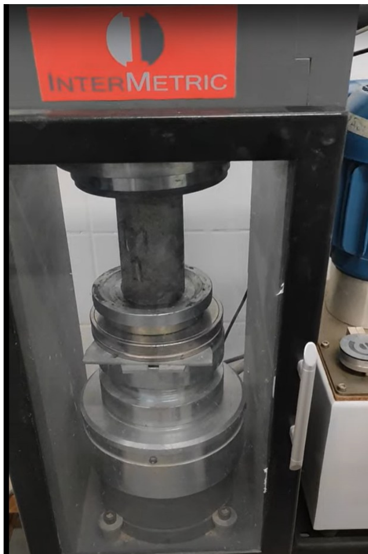
Figura 11 - Prensa utilizada para o rompimento.
