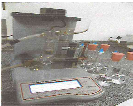
Figura 3 - Determinação do teor alcoólico utilizando a balança hidrostática
