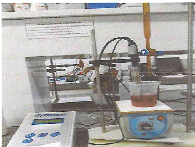
Figura 2 - Titulação dos ácidos presentes no vinho com solução de hidróxido de sódio a 0,1N
