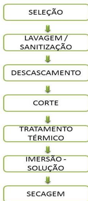
Figura 1: Fluxograma adotado para a casca de banana
