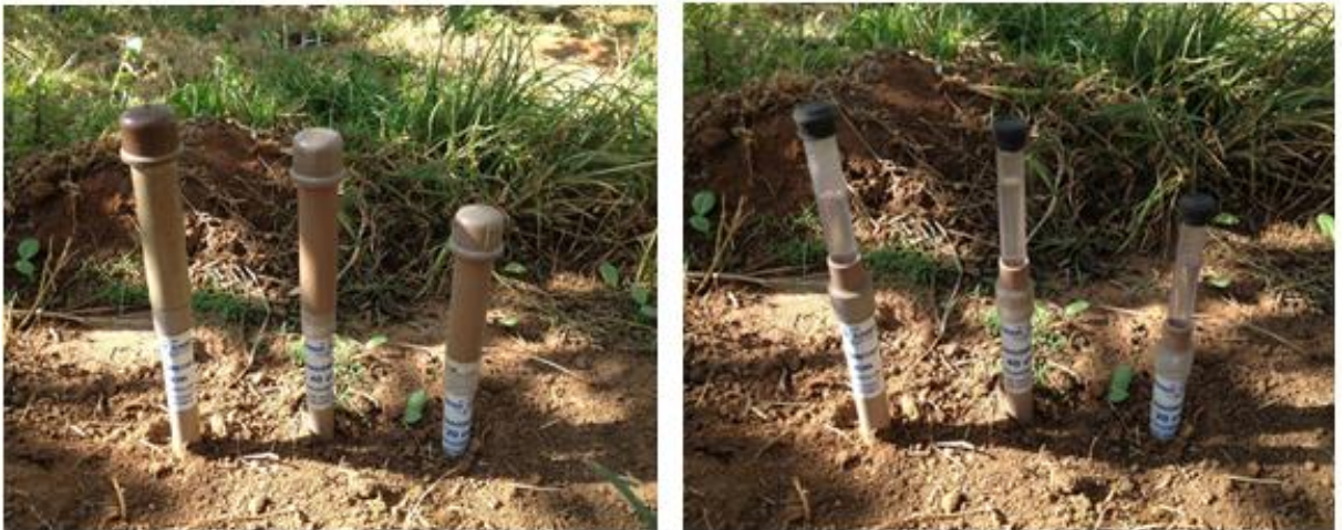
Figura 1- Tensiômetros instalados (0-20, 20-40 e 40-60 cm)
