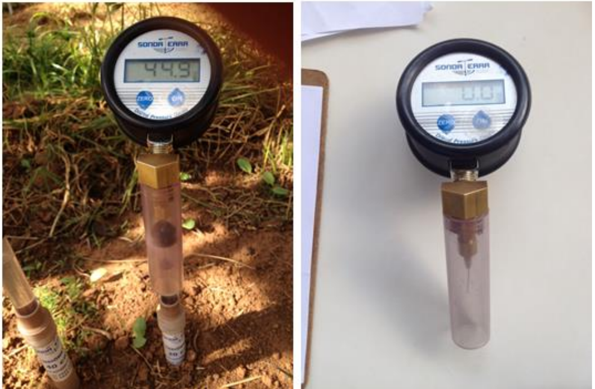
Figura 2 - Vacuômetro adaptado ( tensímetro digital )
