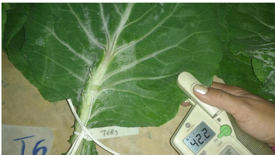
**Figura 3:** Avaliação do teor de clorofila utilizando o medidor portátil SPAD-502.
