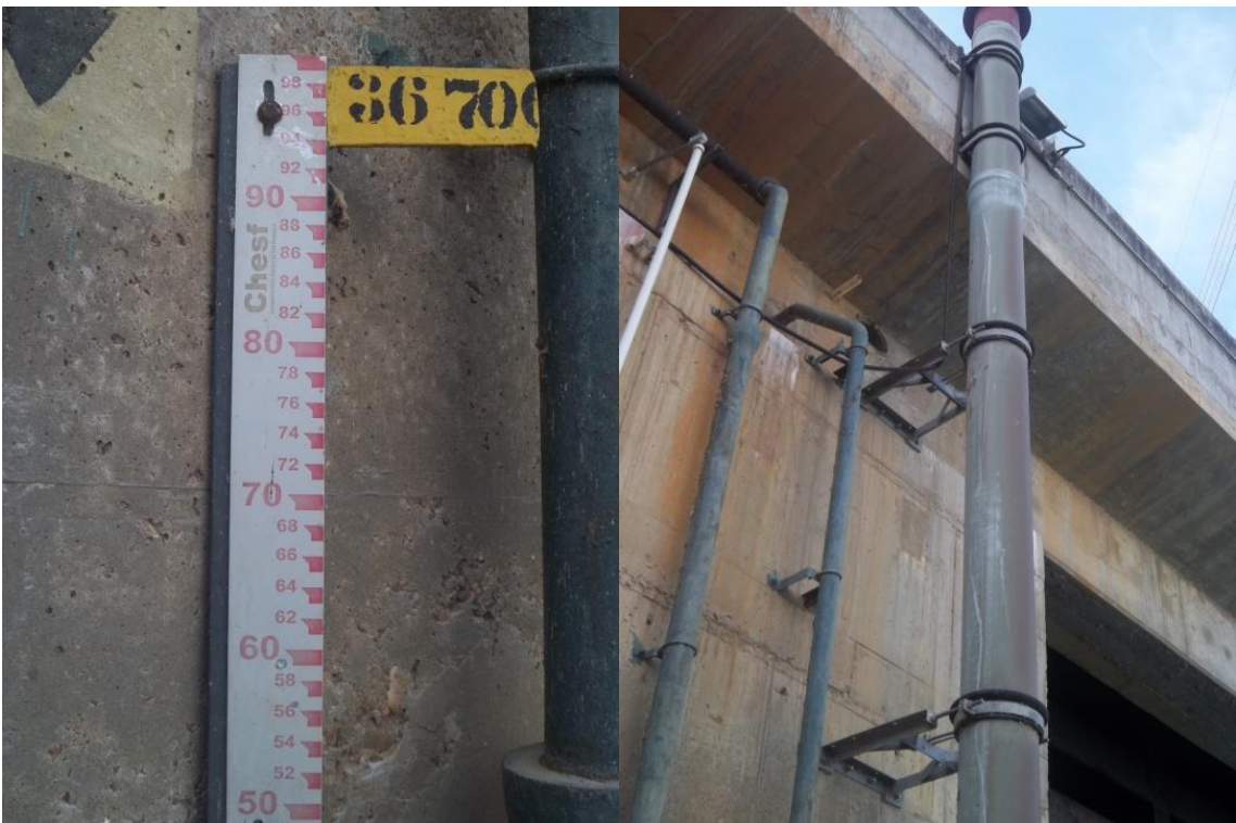
Figura 4A. Linígrafo equipamento automático utilizado para monitoramento do nível de água da barragem de Sobradinho-BA.
