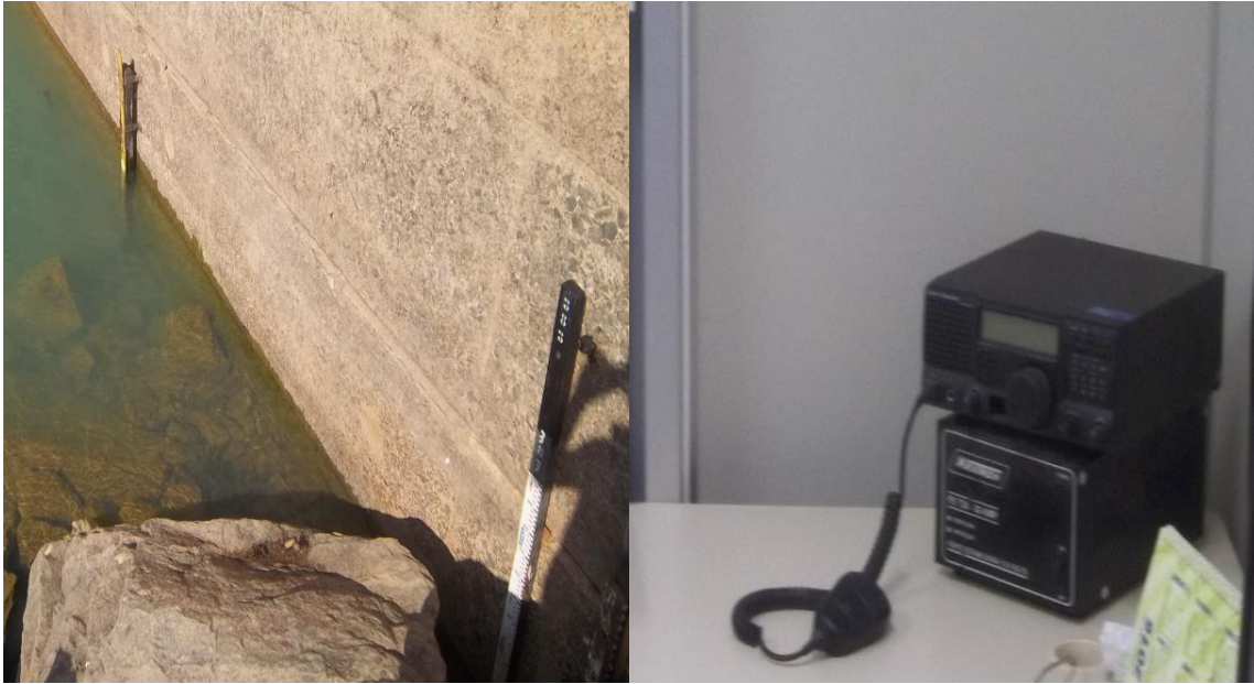
Figura 4A. Linígrafo equipamento automático utilizado para monitoramento do nível de água da barragem de Sobradinho-BA.
