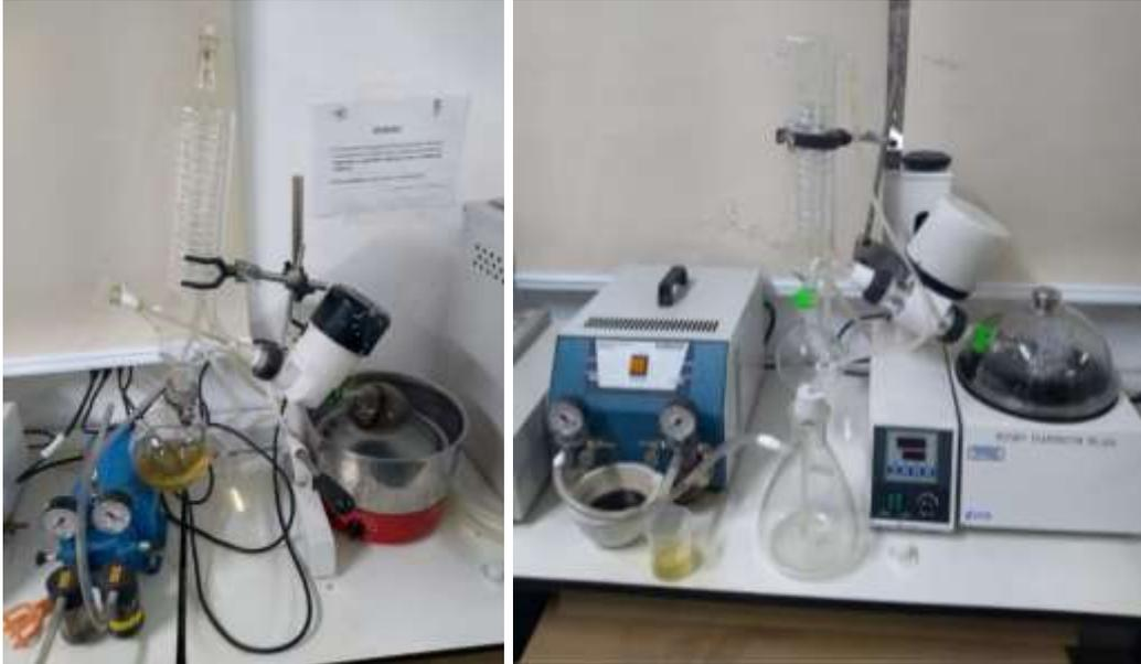
**Figura 1 – A:** Filtrado de cravo da índia; **B:** Filtrado de alho concentrado em rotaevaporador a 40°C, no laboratório de química do IF Sertão-PE.
