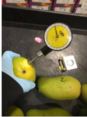
**Figura 3.** Determinação da firmeza da polpa com a utilização do Penetrômetro.
