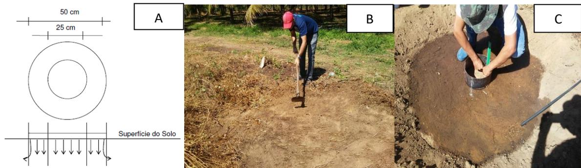
**Figura 16** - Desenho esquemático do infiltrômetro de anel (A). Limpeza da área (B). Preparação da bacia (C).
