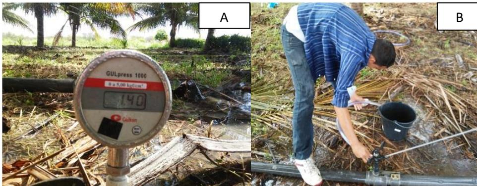
**Figura 15** - Manômetro usado para aferir a pressão da linha de aspersores (A). Coleta da água (B).
