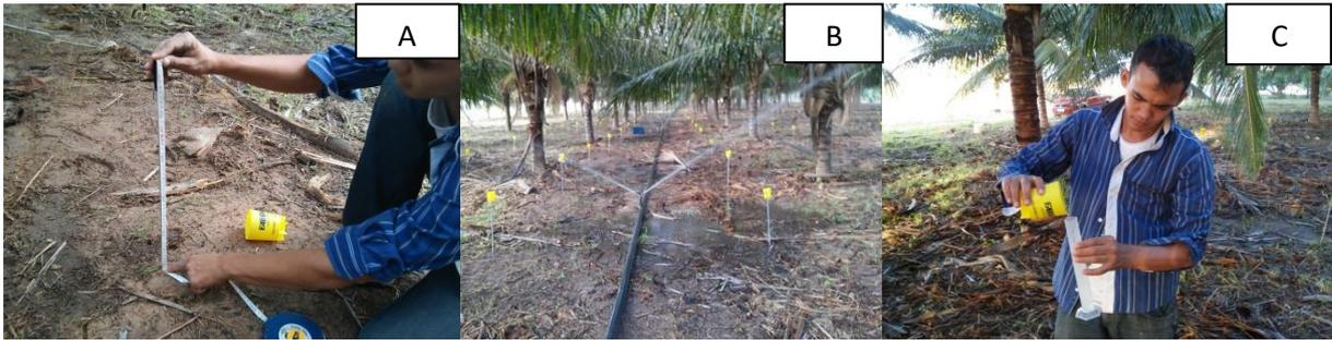
**Figura 19** - Medição da altura da haste (A). Distribuição dos coletores na área (B). Aferição do volume em cada coletor (C).
