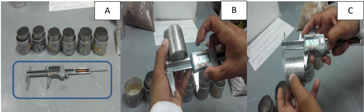
**Figura 12** - Paquímetro digital (A). Aferição do diâmetro do anel (B). Aferição da altura do anel (C).
