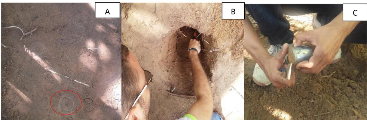
**Figura 9** - Inserção do anel no solo (A). Retirada do anel do solo (B). Nivelamento do anel (C).
