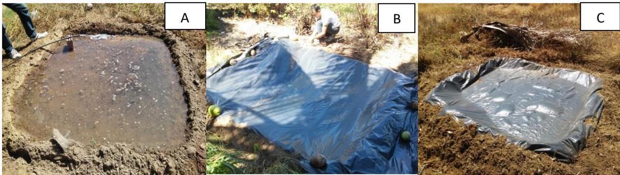
**Figura 7** - Saturação total da bacia (A). Colocação da lona plástica (B). Vedação da área para capacidade de campo (C).
