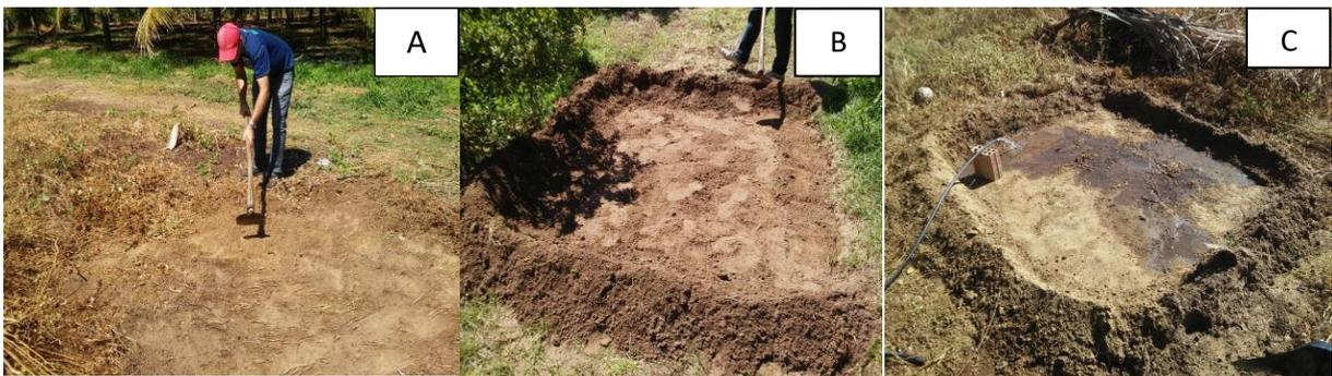
**Figura 6** - Limpeza da área (A). Confecção das paredes da bacia (B). Aplicação do volume de água (C).
