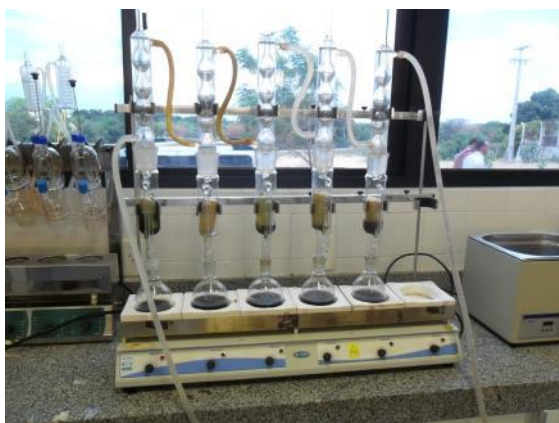
Foto (direita): Extração em aparelho Soxhlet. Foto (esquerda): Extração em aparelho Soxhlet.
