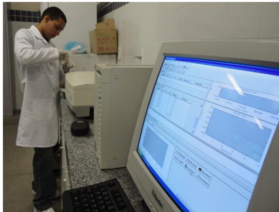
Foto (direita): Leitura de absorvância em espectrofotômetro a 480 nm. Foto (esquerda): Leitura de absorvância em espectrofotômetro a 480 nm.
