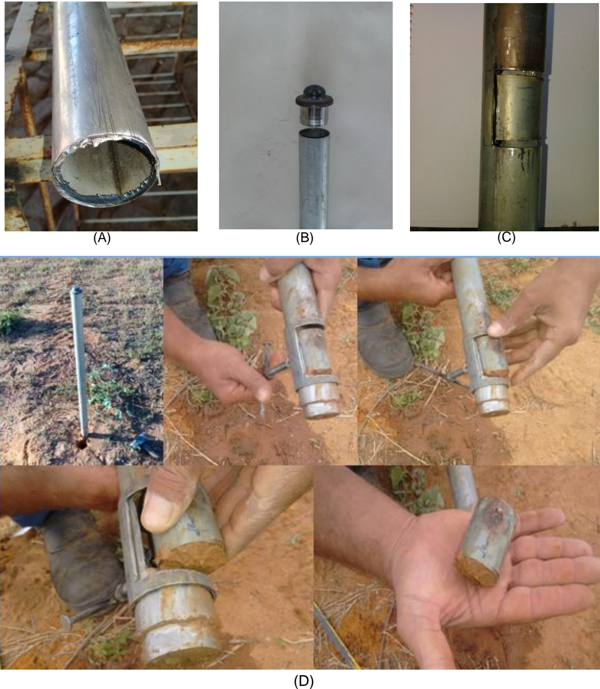
Figura 10 – Trado desenvolvido para coleta de solo e abertura de poços. Tubulação usada (A); tampão adaptado (B); abertura lateral na base inferior do trado para inserção do anel volumétrica (C); obtenção da amostra indeformada de solo (D).
