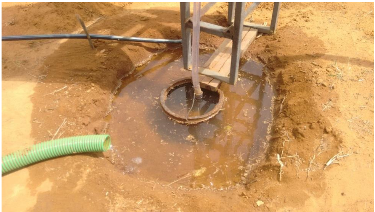
Figura 9 – Ilustração do teste de campo para obtenção da VIB.
