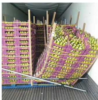
Figura 11: Lote da safra do México com paletes de manga danificado.
