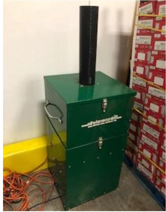
Removedor de gás etileno do ar no cooling.
