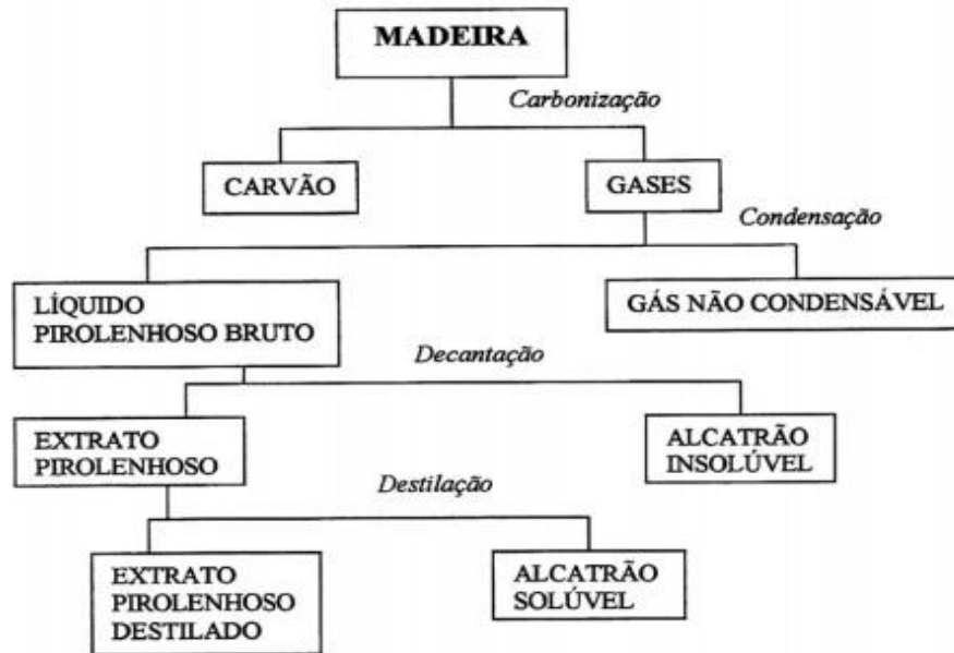
Ilustração 1: Esquema do processo de obtenção do Extrato Pirolenhoso destilado
