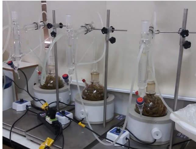
Figura 1: Extração dos óleos essenciais por hidrodestilação em aparelho tipo Clevenger.
