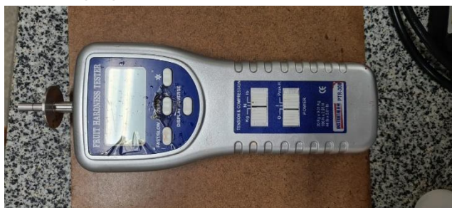
Figura 5. Penetrômetro digital PT óptica 50N com ponteira de 6 mm utilizado para as análises de firmeza da polpa
