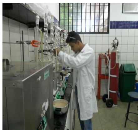
**Figura 17** colocando o biodiesel em sistema de refluxo em banho-maria
