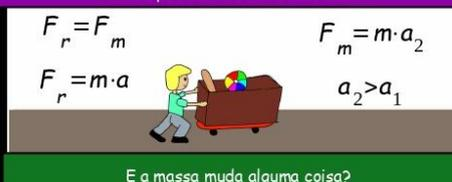
Claro!! Olhando a equação:  $F = m \cdot a$ . Se pensarmos em uma força constante sobre um objeto e aumentarmos a massa, a aceleração vai diminuir para manter a igualdade da equação.
