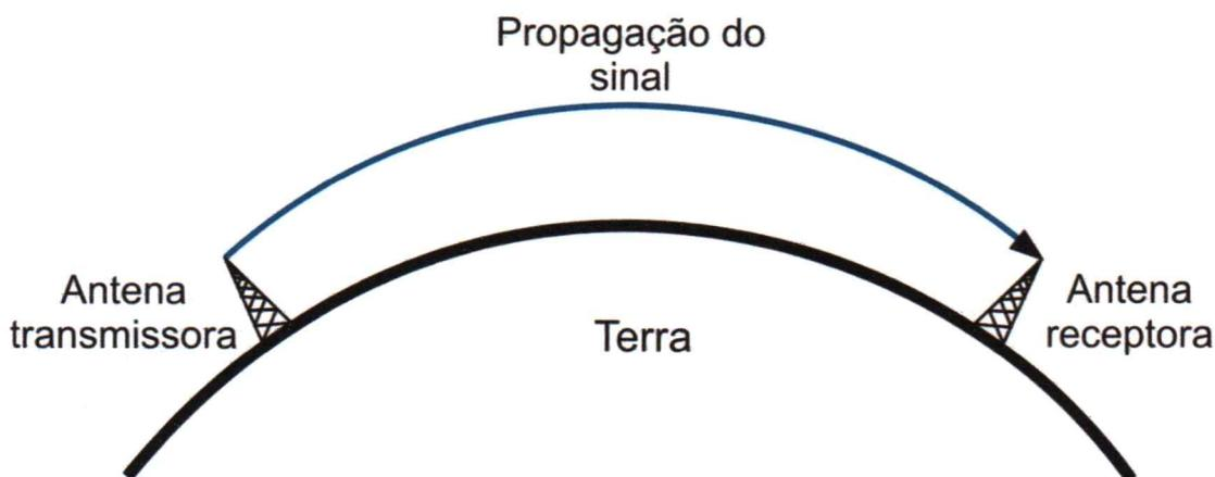
Figura 10 - Propagação por onda terrestre
