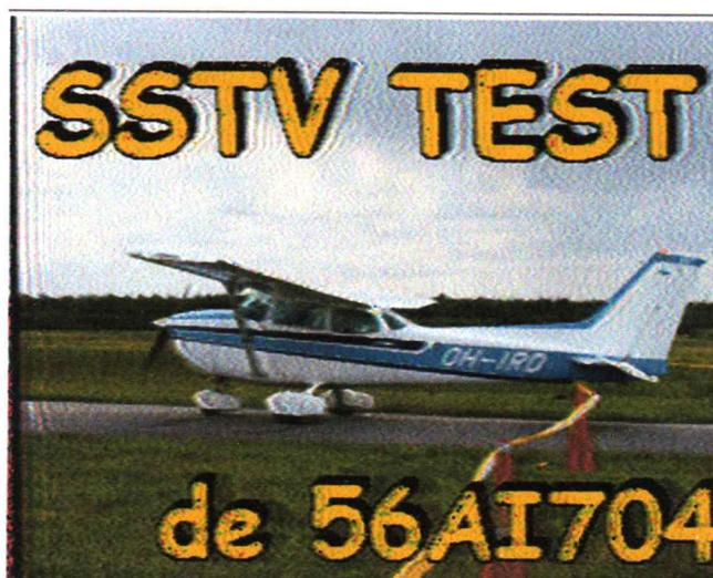
**Figura 26-Imagem enviada via laser com distância de 2 metros e luminosidade alta
