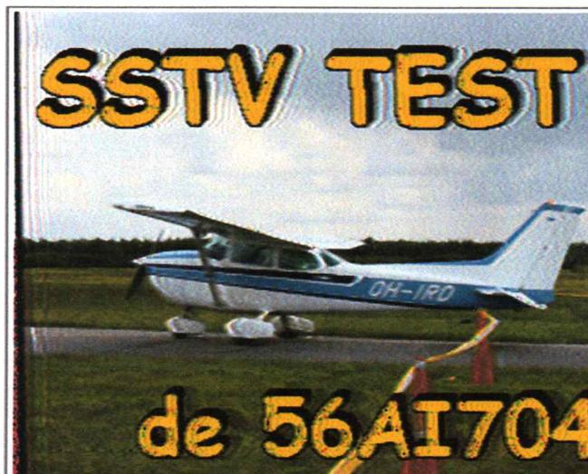
**Figura 25-Imagem enviada via laser com distância de 2 metros e luminosidade baixa
